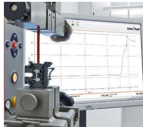
6 mm 2 螺钉端子的拉力测试
