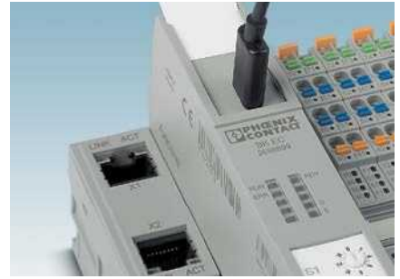
拨码开关和USB接口方便调试和维护
