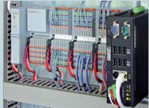
机械制造和系统制造：工业PC机作为系统的中央处理单元
