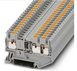
0.5 A, 二极管接线端子, 1N 4007 (1300 V/0.5 A), 一进两出
