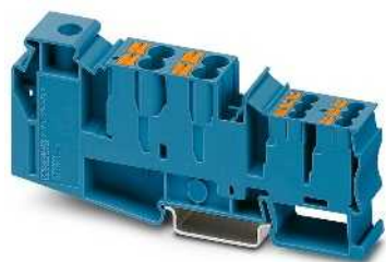
105 A, 电位分配端子, 4个6 mm 2 输入端, 6个2.5 mm 2 输入端
