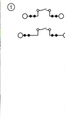
16 A, 双层接线端子, 每层带一个分断刀闸, 斜面设计
