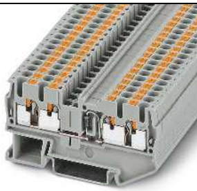
0.5 A, 二极管接线端子, 1N 4007 (1300 V/0.5 A), 两进两出
